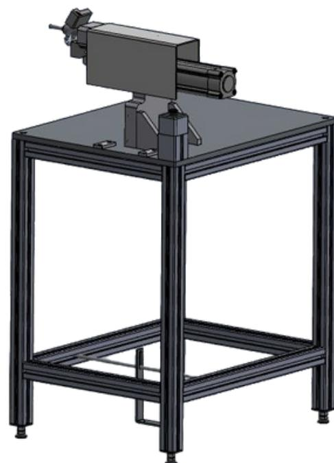
Il tiralacci utilizza un sistema di tiraggio con pistone pneumatico per tirare i lacci del prodotto ad una coppia costante, garantendo uniformità nella produzione e riducendo molto lo sforzo fisico dell'operatore.
