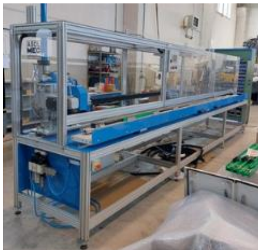
Fustellatrice per profili in gomma con anima in acciaio.
