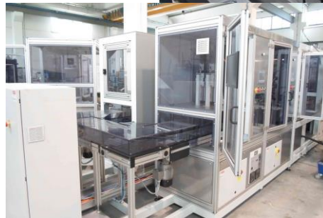
Linea completa di automazioni per l'assemblaggio di componenti di sicurezza.
