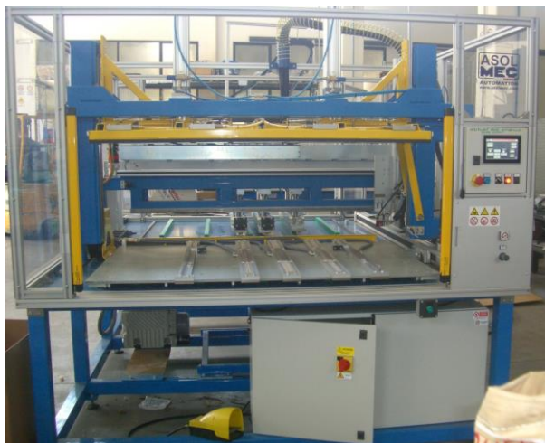
Macchina per la creazione dei dorsi su cartone, deposizione della colla e accoppiamento meccanico del cartone con il foglio.
