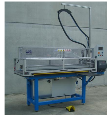
Macchina piegatrice di lembi delle cartelle dopo l'applicazione dell'adesivo.
