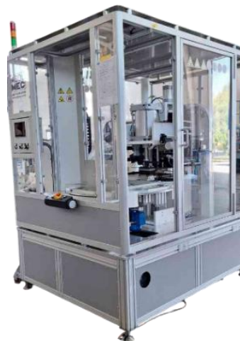
Macchina transfer automatizzata per applicazione di stampa a caldo, dotata di tavola rotante
