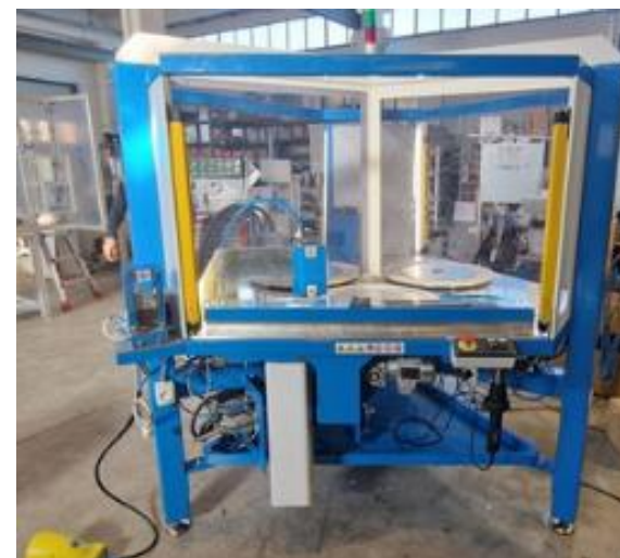
Pulizia con sistema al plasma e applicazione di feltro adesivo.
