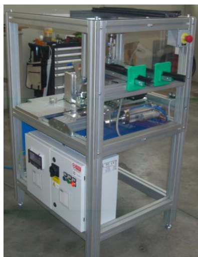
Macchina con teste di taglio per profili in gomma con anima in acciaio.
