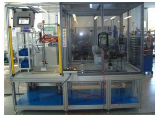
Stazione con robot per assemblaggio, marcatura e controllo qualità di filtri d'aria per automobili
